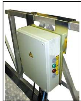
32 pav. Centrinio valdymo pulto tvirtinimas.
